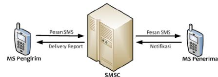
Gambar 2.1. Gambar Mekanisme Pengiriman SMS
